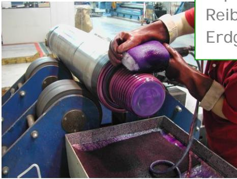
Kupferbeschichtungen als Reibschutz in der Erdgas- Erdöltechnik
